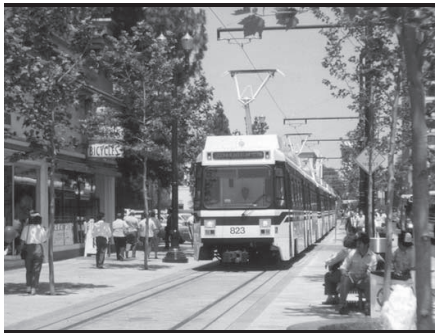
شکل شماره ۲-۲: مسیر هم‌سطح قطار سبک شهری در یک پیاده‌راه، مجزا از سایر جریان‌های ترافیک، سن خوزه، آمریکا
