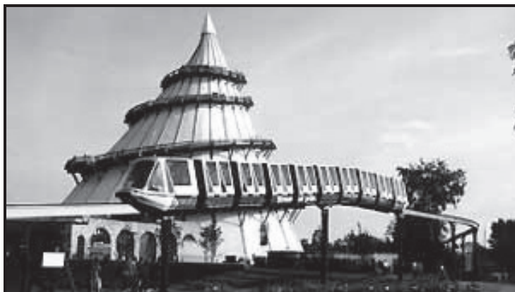
شکل شماره ۳-۱۰: یک مسیر حلقوی و قطار فقط در یک جهت حرکت می کند، مونوریل مگدبورگ
