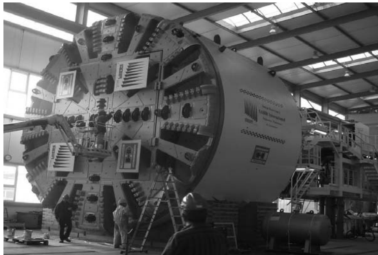
شکل ۴۵-۵: ماشین EPB به قطر ۹/۱۹ متر برای حفاری بخشی از تونل خط ۳ مترو تهران
