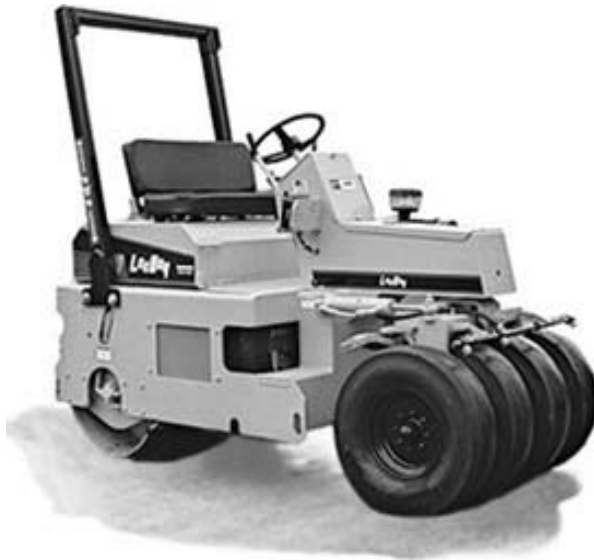
شکل ۸-۱۳: غلتک پنوماتیک با قابلیت تغییر فشار باد لاستیک
