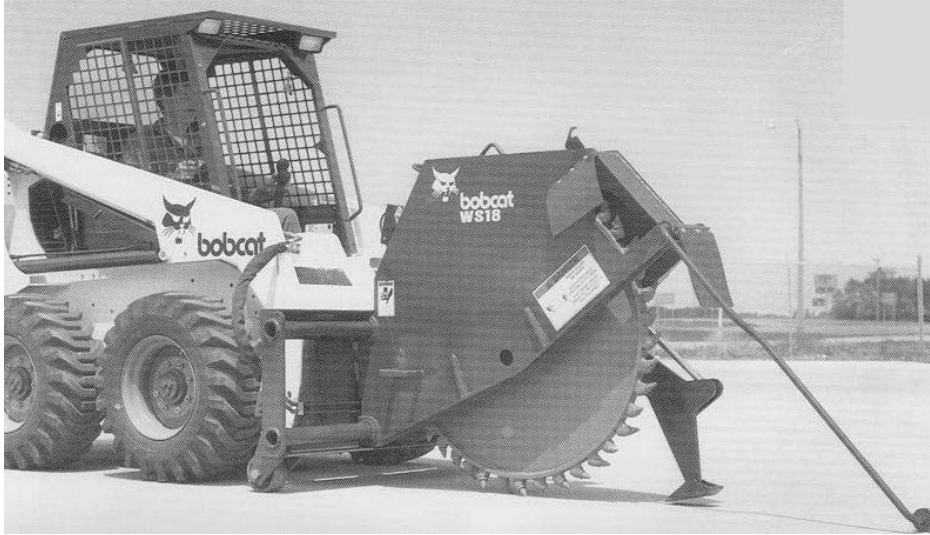
شکل شماره ۸-۱۹: بابکت تجهیز شده برای تراش آسفالت
