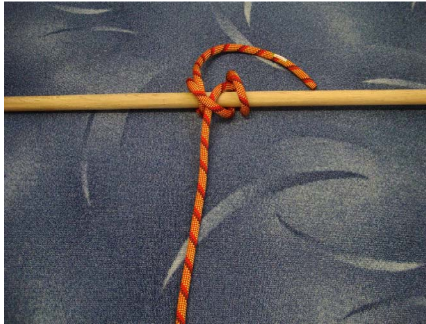
شکل شماره ۱-۶۰: مرحله پنجم بستن گره شکاف‌دار با یک حلقه
