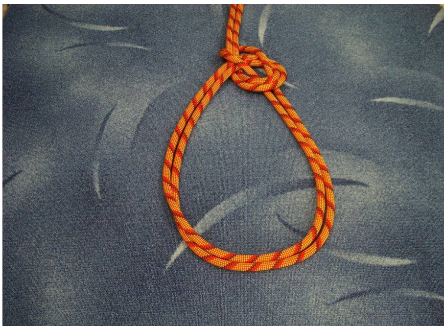
شکل شماره ۹۵-۱: مرحله پنجم بستن گره خرگوش به روی قوس
