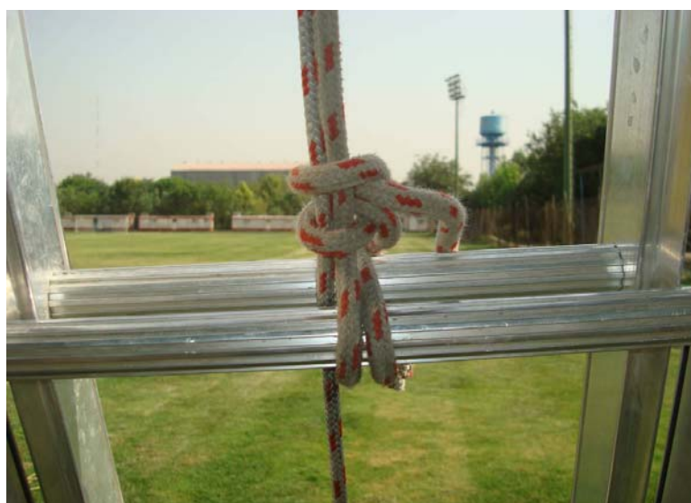
شکل شماره ۳-۱۳. گره یک حلقه و دو نیم خفت بر روی پله نردبان را نشان می‌دهد. با بستن این گره بر روی پله نردبان باعث می‌شود که قسمت متحرک نردبان ثابت بماند و ضریب ایمنی نردبان بالا رود.
