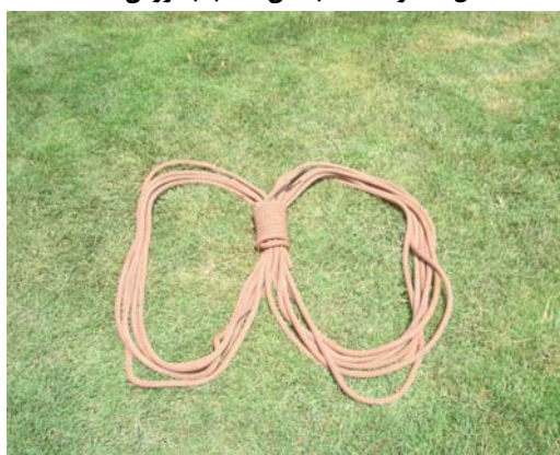
شکل شماره ۲-۴: بستن طناب به روش حلقه جهت حمل همانند کوله پشتی
