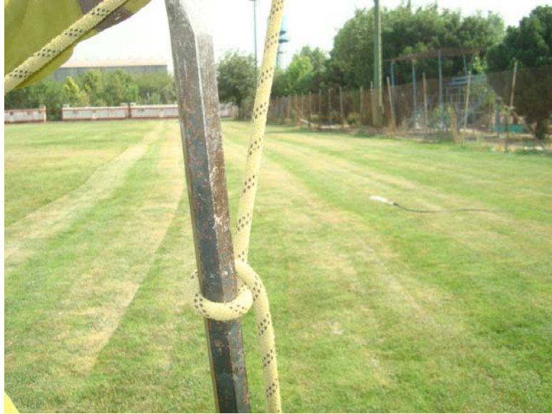
شکل شماره ۳-۶. گره نیم خفت در قسمت بالای دیلم باعث می‌شود که دیلم نیز بصورت عمودی بالا رود و به موانع سر راه خود برخورد نکند.
