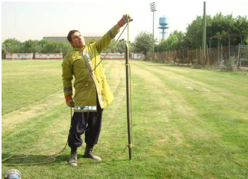
شکل شماره ۳-۷. گره شکاف‌دار با یه حلقه اضافه در قسمت پایین دیلم و گره نیم خفت در قسمت بالای دیلم را نشان می‌دهد.
