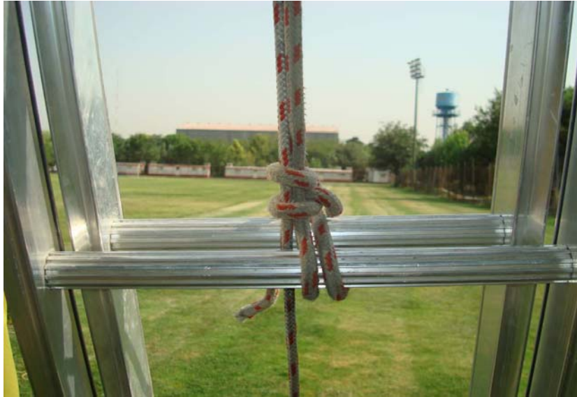
شکل شماره ۳-۱۴. گره یک حلقه و دو نیم خفت بر روی نردبان جهت ثابت کردن نردبان
