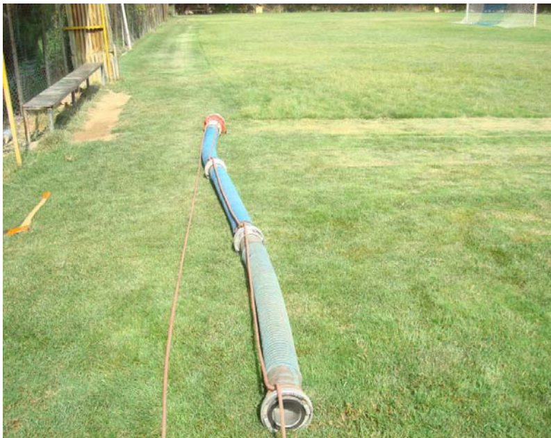
شکل شماره ۳-۱۱. گره نیم خفت بر روی لوله‌های خرطومی را نشان می‌دهد. همانطور که در شکل نشان داده شده است بر روی هر لوله خرطومی فقط یک گره نیم خفت زده شده است.
