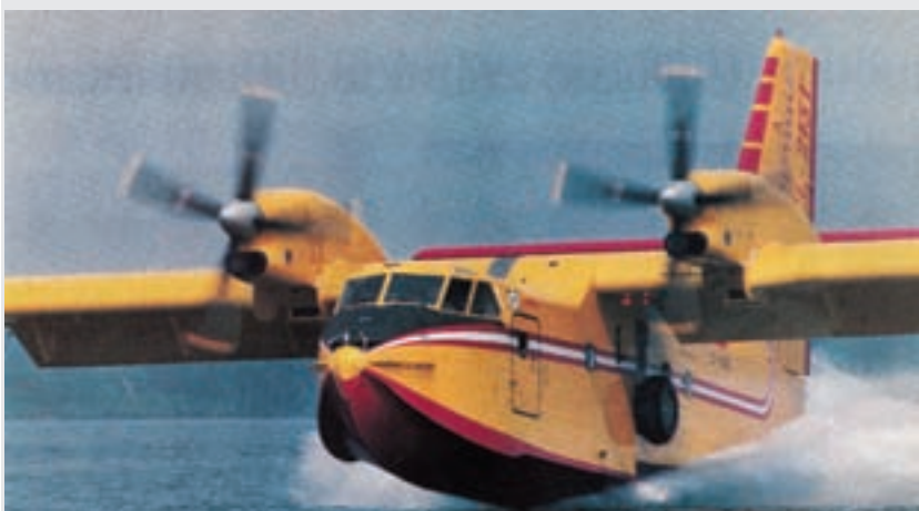
هنگام حرکت روی آب طی ۱۰ ثانیه مخازن هواپیما از آب پر می شود
