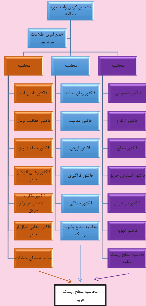
شکل ۲: فلوچارت مراحل انجام ارزیابی ریسک حریق به روش
