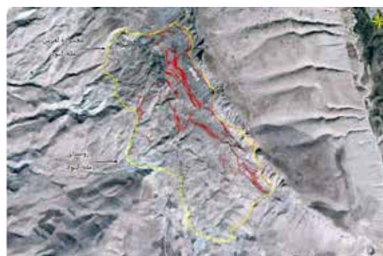
شکل ۴. ب: محدوده زمین لغزش مله کبود (دید به سمت شمال)، ترک های کششی ایجاد شده در محدوده لغزشی مله کبود
