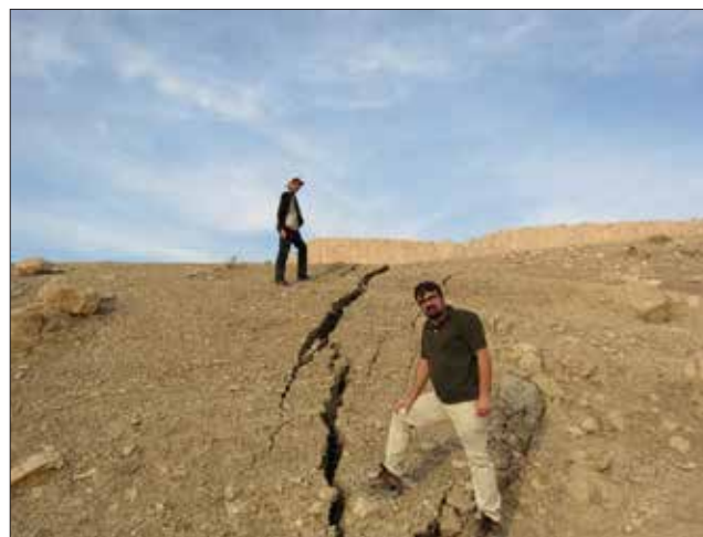
شکل ۸. ترک‌های کششی که در انتهای لغزش و نزدیک پنجه لغزش ایجاد شده‌اند
