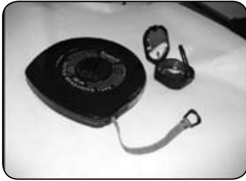
(تصویر شماره ۳) تجهیزات مورد استفاده جهت اندازه‌گیری شیب در پارک لاله
