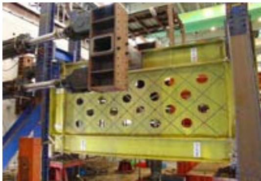
شکل ۳. نمایش نحوه بارگذاری و آرایش بازوها در نمونه وین و برونیو
