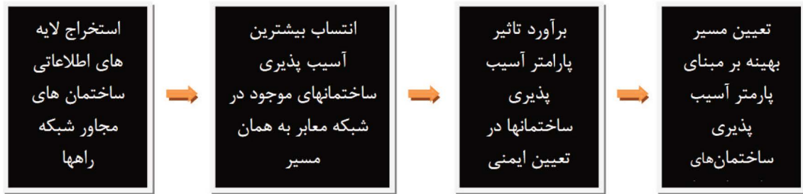
شکل ۵. روش برآورد پارامتر آسیب پذیری ساختمان‌های مجاور شبکه معابر و مدل سازی آن
