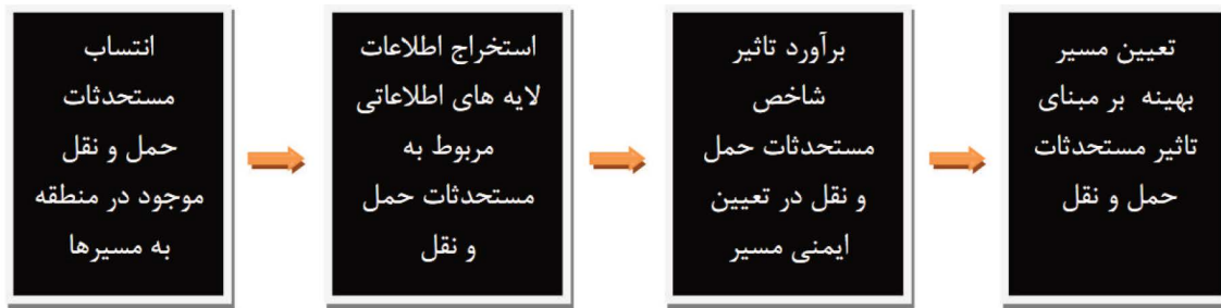
شکل ۳. روش برآورد شاخص مستحذات حمل و نقل و مدل سازی آن
