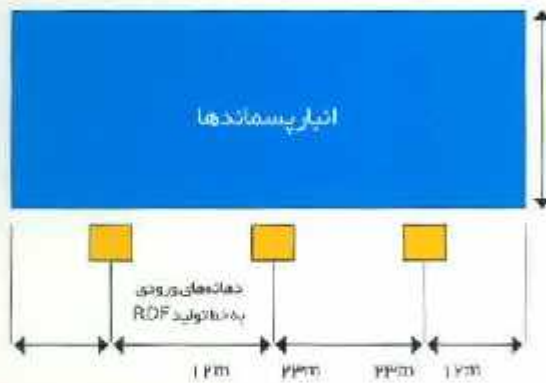
شکل شماره ۴: پلان انبار پسماند و موقعیت دهانه ورودی به خط تولید سوخت حاصل از پسماند
