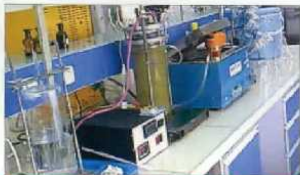
شکل شماره یک: نمای کلی دستگاه هضم بی‌هواری
