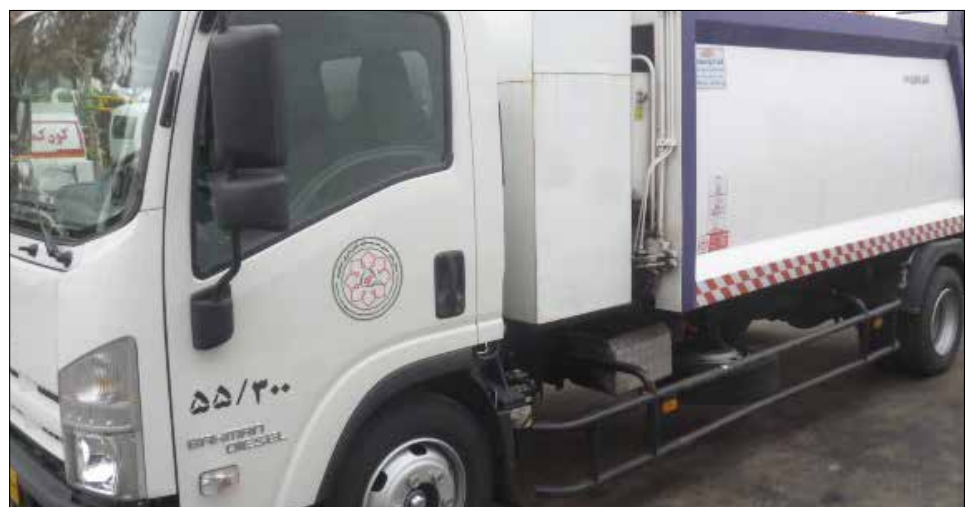
خودروی حمل پسماند مجهز به فضای جمع‌آوری همزمان پسماند خشک و تر
