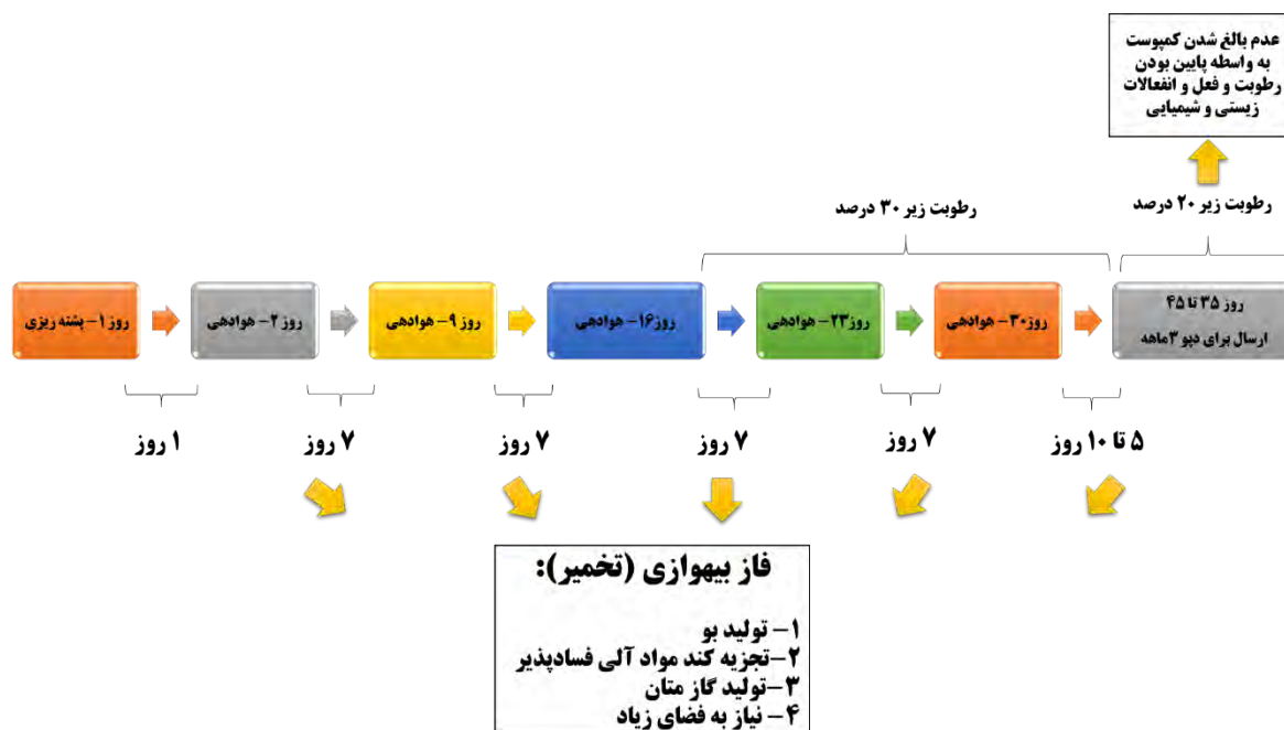
شکل ۲- فرایند تولید کمپوست به روش فعلی در مجتمع آرادکوه
