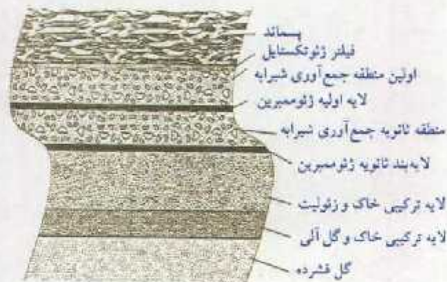
شکل ۶: نمایی از سیستم لایه‌بندی ترکیبی برای تسهیلات دفن پسماندهای خطرناک
