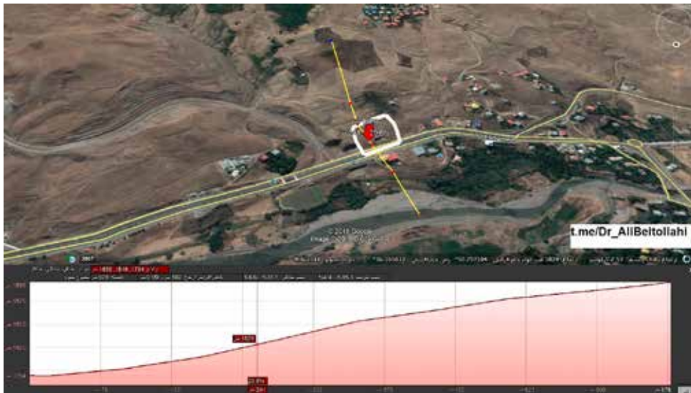
شکل ۷- پروفیل ارتفاعی عبوری از محل رانش زمین بطول ۶۸۰ متر از رودخانه شاهرود تا ارتفاعات بالادست توده‌ی رانشی
