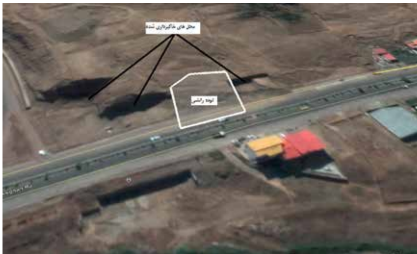
شکل ۱۱ - محل رانش و محل های خاکبرداری شده بودن سازه نگهدمان
