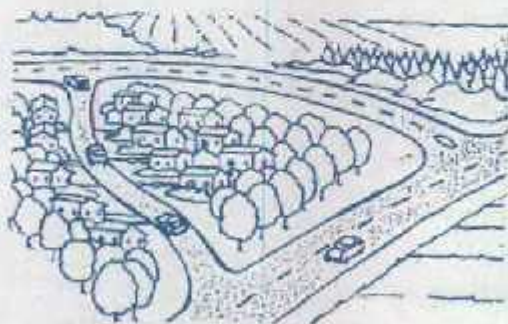
۱- طرح نامناسب برای شبکه راهها که راه دسترسی باعث جذب ترافیک عبوری می‌شود.
