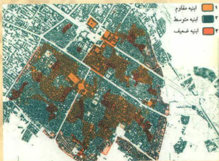
تصویر ۳. تعیین وضعیت استحکام و مقاومت ساختمان‌های موجود
