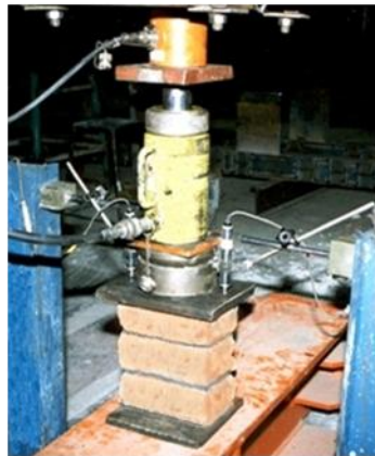
شکل ۲-۲- نحوه انجام آزمایش منشور آجری در آزمایشگاه
