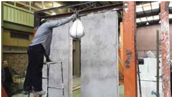
شکل (۵-۱) آزمایش ضربه جسم نرم سنگین
