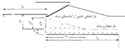
شکل ۶-۷-۶-۸ نمایش برف انباشته شده بر بام پایین‌تر
